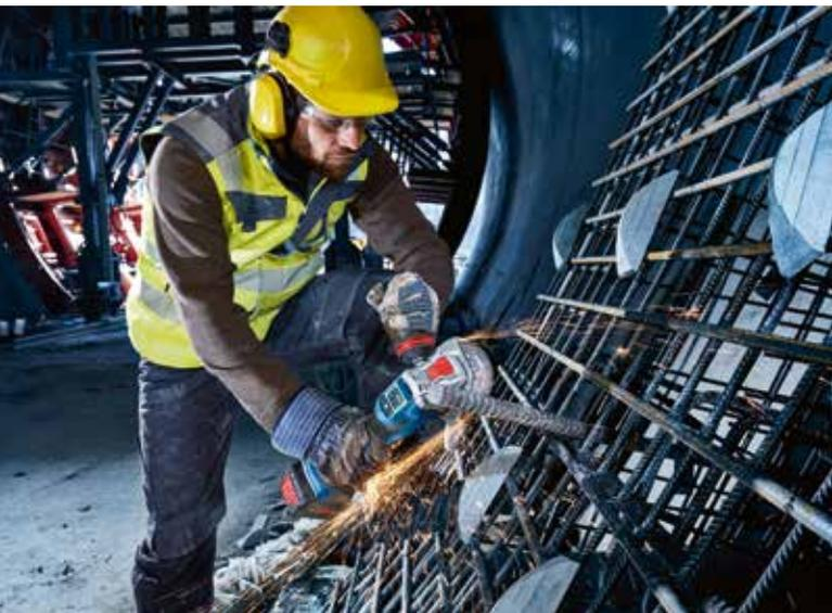
Un nuovo punto di riferimento **IN TERMINI DI PROTEZIONE E SICUREZZA** grazie agli avanzati sistemi KickBack Control e Drop Control e al sistema di arresto intelligente ultra veloce X-Brake (modello GWX).
